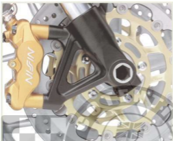
Les étriers de freins radiaux sur des disques flottants de 320mm procurent un freinage sûr et efficace.
